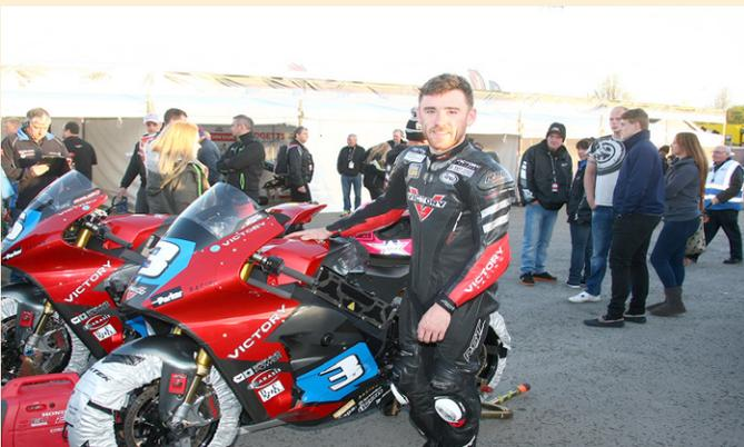
Lors du dernier SES TT Zéro Challenge sur l'île de Man, deux motos de course prototypes Victory Racing propulsées par des moteurs électriques Global Vehicle Motor (GVM) de Parker Hannifin ont été à l'honneur. D'un poids limité à 220 kg, ces motos disposent chacune d'un moteur de course électrique, de puissantes alimentations dédiées ainsi que de variateurs sophistiqués pour maximiser la puissance et le temps de fonctionnement.
