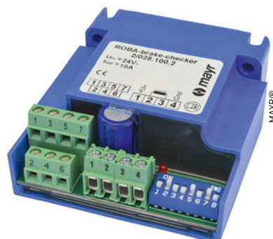
Le module Roba®-brake-checker ne contrôle pas que les états de commutation, mais aussi les réserves de course de freinage et de force de traction.
