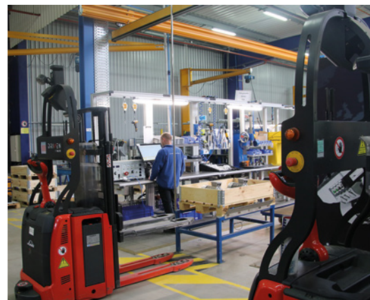
Les véhicules autonomes Balyo récupèrent les réducteurs
