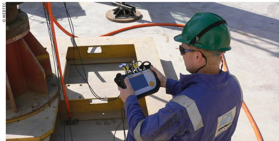
Quelques semaines plus tard, Hyco était en possession d'un kit de location avec des capteurs capables de mesurer deux débits, six pressions et six températures.
