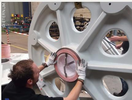
sateurs de navires), les rotules maritimes sont utilisées dans des embouts de vérins ou de cylindres hydrauliques, dans des tiges de tractions ou dans des charnières, pour compenser les défauts d'alignement de l'arbre avec le logement du palier » indique Johan Tiellemans, dirigeant d'Eternum France. « Dans des environnements humides et souillés, il est
