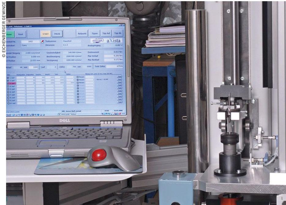
Le département de recherche et développement effectue des tests d'endurance pour comparer les différentes géométries, les lubrifiants et la durée de vie.
