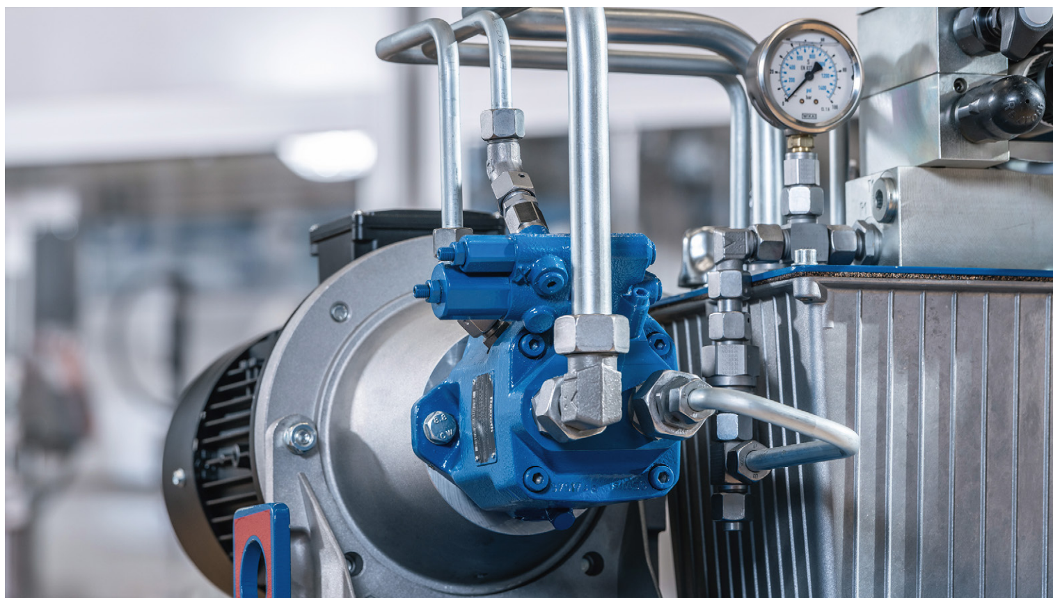
La solution Sytronix FcP de Bosch Rexroth est constituée d'un groupe motopompe avec moteur asynchrone standard et d'un convertisseur de fréquence (application technologique de gestion des débits et des pressions).
