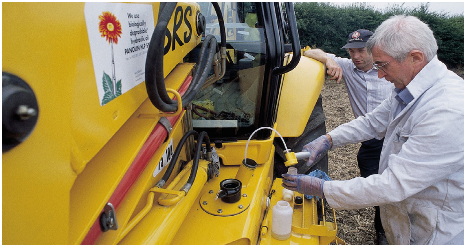
Le flushing est l'opération par laquelle une huile hydraulique est remplacée par une autre. La réglementation tolère 2% d'huile résiduelle.
