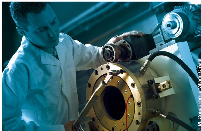
Matériel R&D - Banc rotatif à forte excentration pour joints à lèvres (200 bar maxi)
