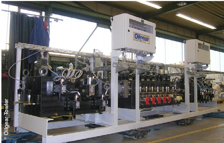
Nouvelles générations de blocs forés et valves Oilgear
