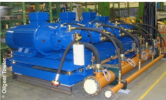
Station de Groupes pompes PVV Oilgear et moteurs VFD
