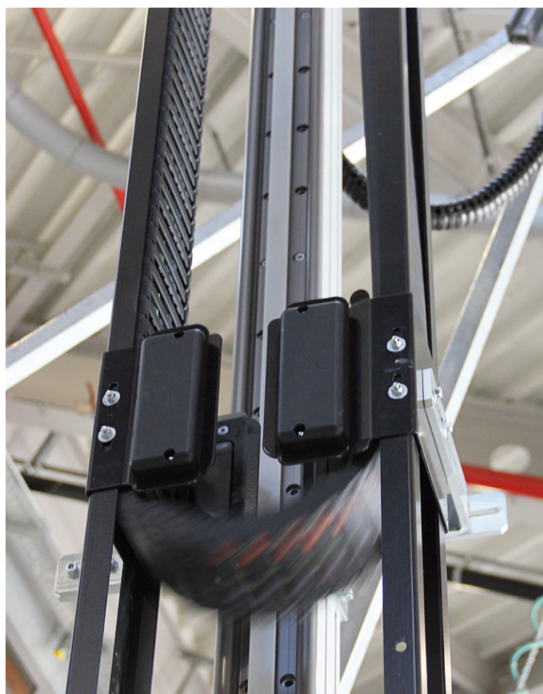
La nouvelle norme pour les transstockeurs : le système guidelok slimline F de la société igus pour les hauteurs de mâts jusqu'à 50 m, les vitesses atteignant 7 m/s et les accélérations jusqu'à 10 m/s 2 . Les applications à chaînes porte-câbles verticales n'ont ainsi plus besoin de structures compliquées telles que les goulottes fermées.
