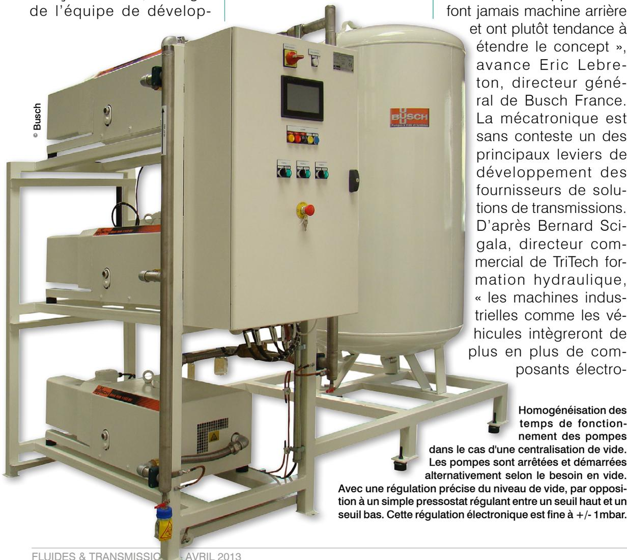
Homogénéisation des temps de fonctionnement des pompes dans le cas d'une centralisation de vide. Les pompes sont arrêtées et démarrées alternativement selon le besoin en vide.
