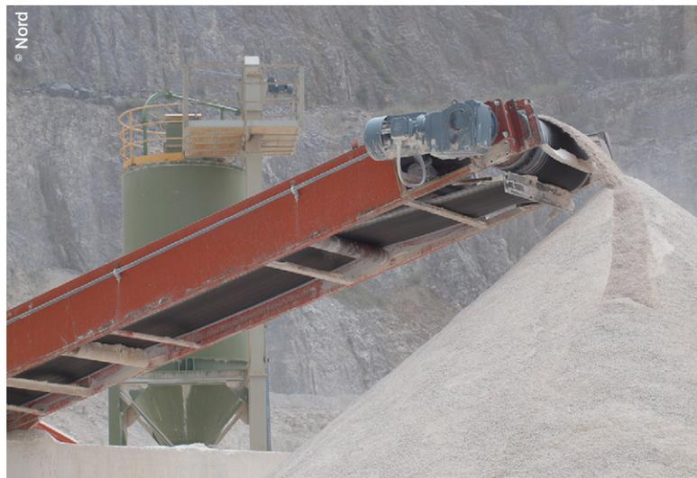
Motoréducteur à engrenages hélicoïdaux Nord entraînant un convoyeur à bande.
