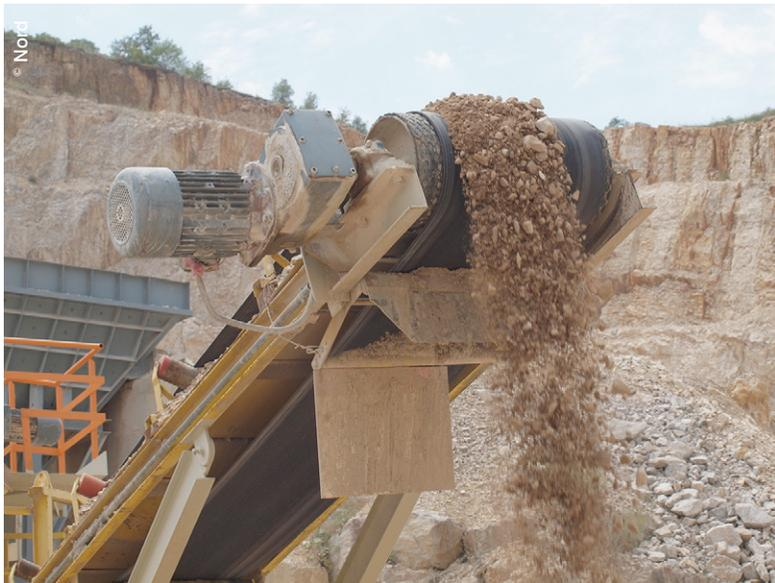
Motoréducteur à arbres parallèles Nord entraînant un convoyeur à bande.
