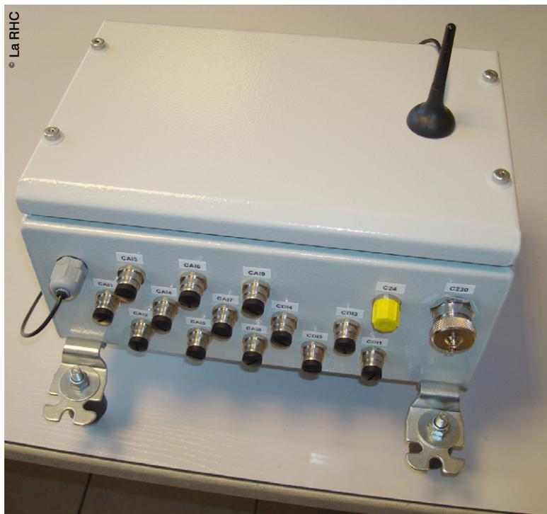
L'offre du réseau s'élargit dans le domaine de la télémaintenance avec le lancement d'un boîtier permettant la récupération de données sur les machines mobiles et stationnaires.
