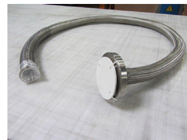
Flexible PTFE convoluté, 1 tresse 304, DN 50, lght. 2350 mm, équipé d'un raccord tri-clamp Dn ext. colerette 77.5 mm en Alloy 926 + ressort de limitation de courbure inox 304 lg. 500 mm et d'une bride PN 10/16 inox 316 Ti DN 50 tournante sur collet inox 316L + PTFE rabattu sur face de collet
