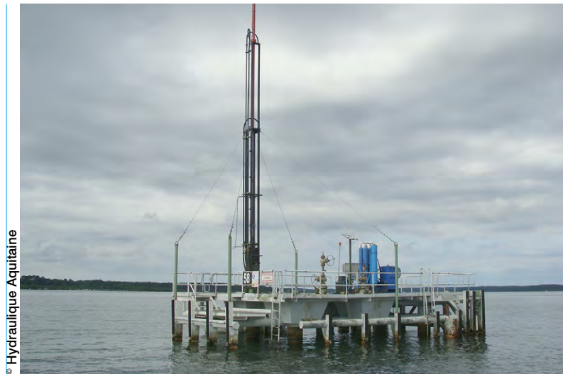
Quatre des puits forés sur le gisement du Lac de Parentis présentent la particularité d'utiliser des groupes oléohydrauliques pour pomper le pétrole.
