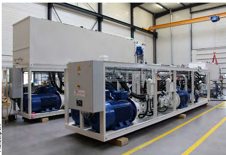
© Fluidexpert L'atelier de Fragnes abrite actuellement les skids hydrauliques destinés aux tunnels NFM qui seront utilisés pour la réalisation du métro de Sao Paulo, au Brésil
