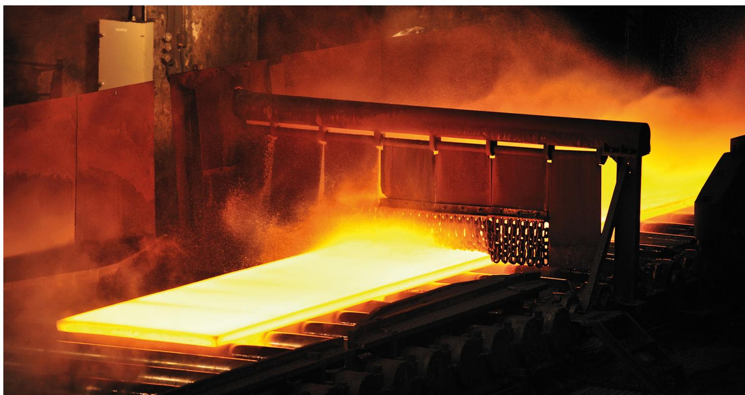
Exemple de train à chaud : une brame chauffée à blanc est transportée sur les rouleaux.
