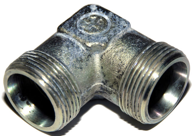
Après 500 heures : premières traces de rouille blanche.
