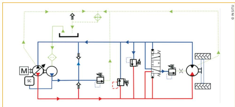
cette raison, les filtres sur cette ligne sont rares. S'ils sont imposés, ils devront être dimensionnés avec le plus grand soin. La valve d'échange dans les circuits hydrostatiques peut assurer le balayage des carters. Elle dirige l'huile de la ligne dite Basse Pression au travers du carter du
