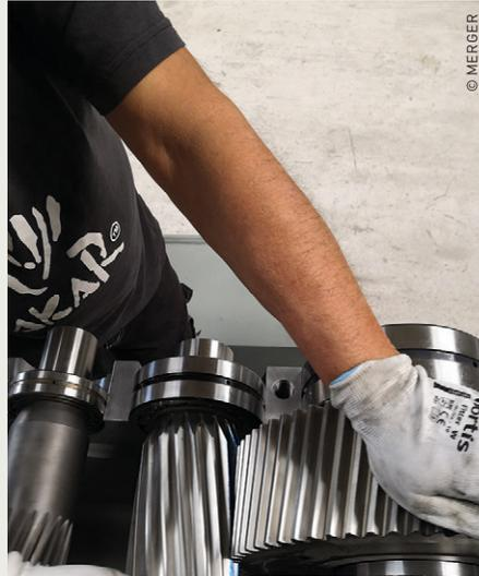
Lorsque la pièce est encore viable mécaniquement, Merger propose par exemple le rechargement par chromage ou par métallisation (ajout d'une couche de protection sur les pièces contre l'usure).
