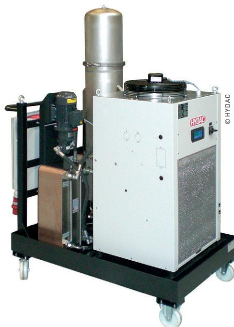
Le groupe de filtration VEU-F (varnish elimination unit) d'Hydac, permet l'élimination des produits de dégradation de l'huile solides ou gélatineux.
