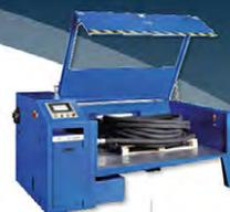
Banc pour tester des couronnes de tuyau sur palette, jusqu'à **800 bar**, avec multiplicateur hydropneumatique
