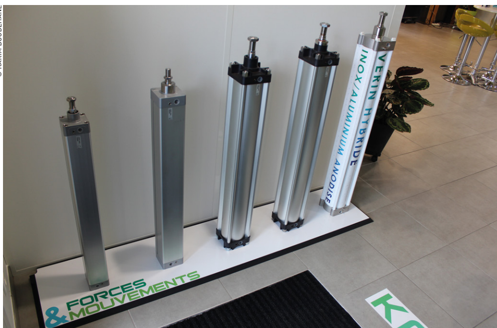
Tout à fait à droite, le vérin avec nez en inox démontable et tube en aluminium anodisé, pour les milieux agressifs.
