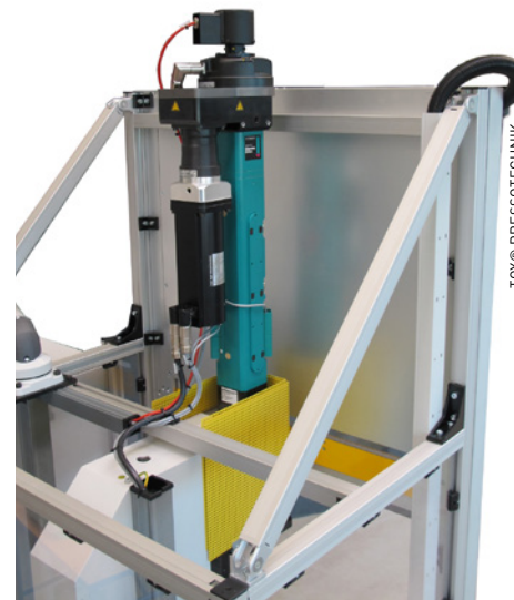
Servopresse de type Tox®-Electric Power Module EPMK 055 montée sur la presse en col de cygne CMB en format compact pour des efforts de pressage pouvant atteindre 55 kN.
