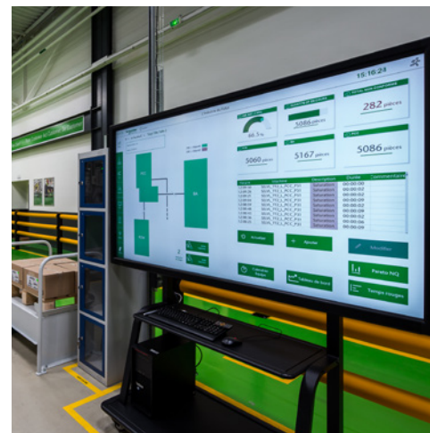
Le management de la performance a été grandement amélioré sur le site du Vaudreuil avec la mise en œuvre d'outils digitaux permettant de visualiser en temps réel les différentes données de production.
