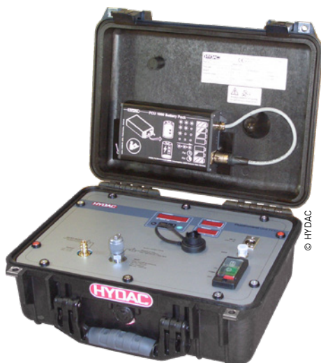
Les prélèvements d'huile réalisés par Hydac et les mesures effectuées avec un contrôleur de pollution permettent une surveillance des fluides sur une longue durée.
