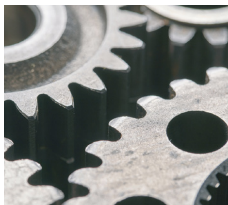
Les engrenages nécessitent peu d'entretien et peuvent fournir des forces élevées sur de courtes distances, le tout avec un accouplement sans glissement.
