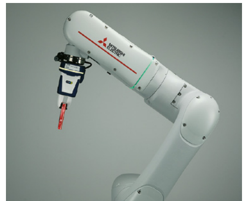
Le cobot Melfa Assista a été conçu pour travailler à proximité des opérateurs sans avoir besoin de dispositifs ou de barrières de sécurité.
