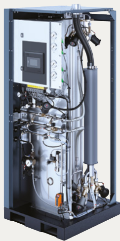
Atlas Copco a optimisé la technologie d'absorption par inversion de pression pour améliorer l'efficacité de son nouveau générateur d'oxygène OGP+.
