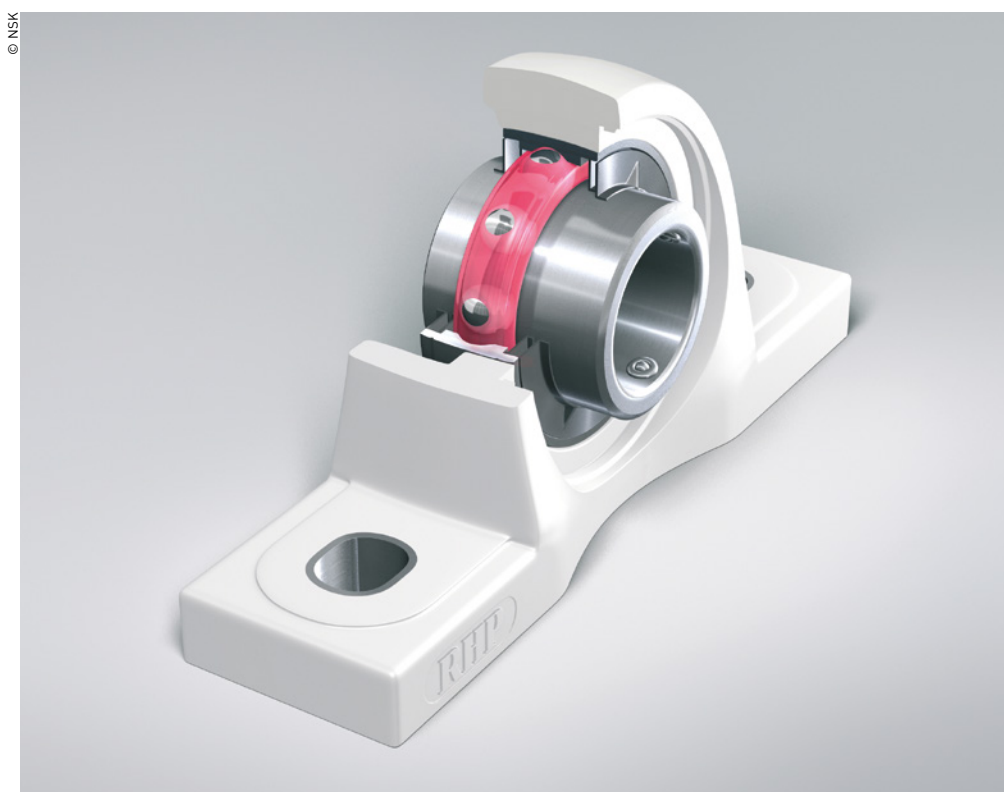
Vue en coupe d'un palier Life-Lube, montrant l'insert en acier inoxydable et la lubrification Molded-Oil.
