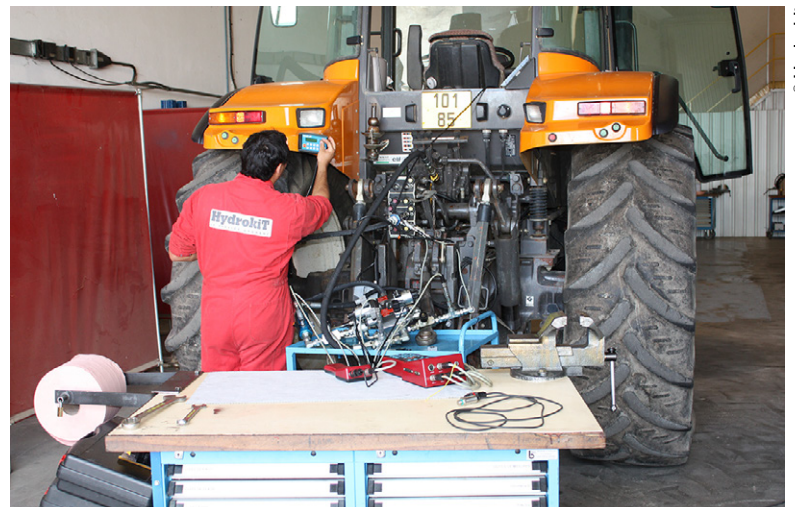
Contrôle hydraulique sur un tracteur.
