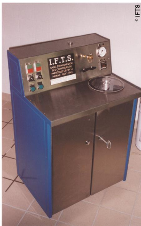
Banc d'étalonnage de compteurs automatiques de particules et d'indicateurs de contamination
