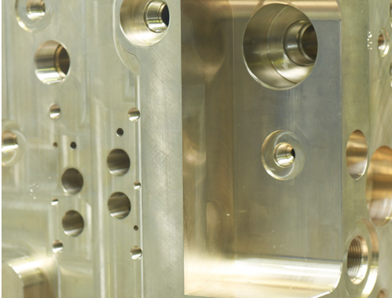
L'utilisation des machines cinq axes permet de travailler les blocs sur toutes leurs faces sans avoir à les démonter à chaque opération et de définir des solutions spécifiques répondant aux besoins précis des clients.
