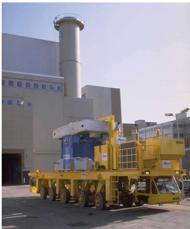
Transfert des déchets vitrifiés de l'atelier T7 à celui de désentreposage de NPH. AREVA, établissement de La Hague. France.
