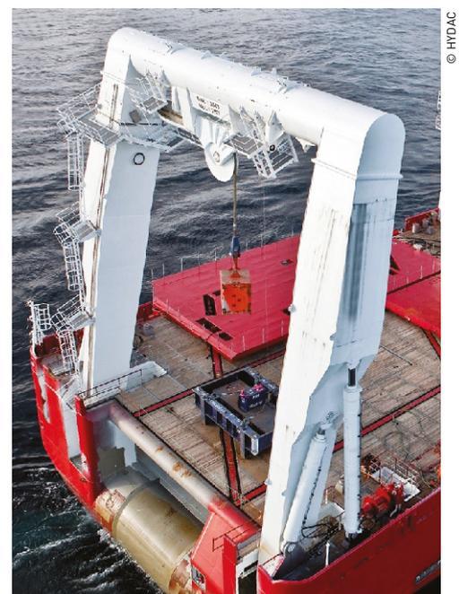
Vérin de diamètre 550 monté sur châssis en A.
