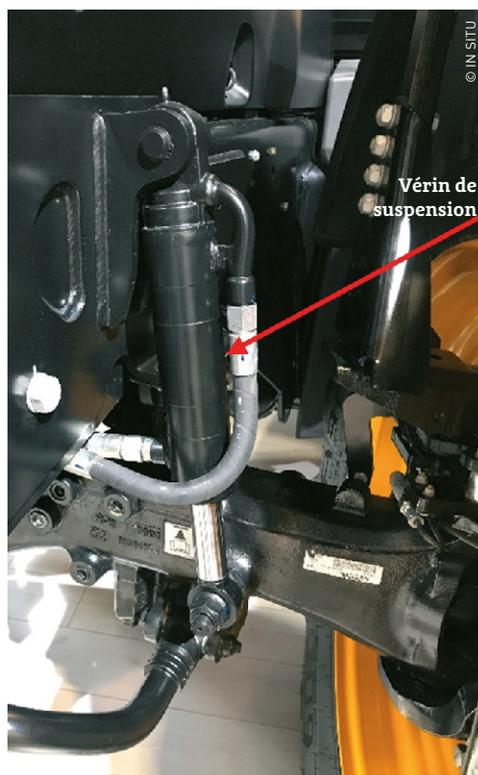
Il existe de nombreuses cinématiques de pont avant suspendus, dont le pont avant suspendu simplifié (Cf. Schéma 1). La suspension est généralement réalisée par deux vérins hydrauliques double-effet reliés à des accumulateurs hydropneumatiques à membranes et pilotés par une valve de suspension.
