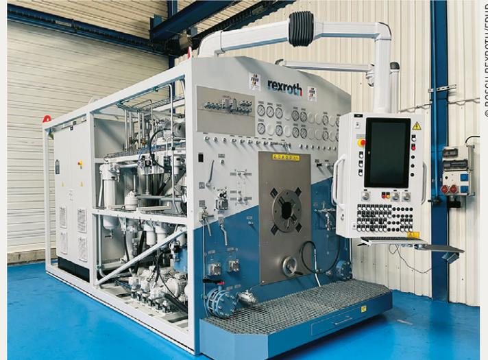
EDHD s'est équipé, en 2022, d'un banc d'essai ultraperformant Bosch Rexroth capable de vérifier et de tester 90% des pompes hydrauliques dans les mêmes conditions qu'en usine Bosch Rexroth.
