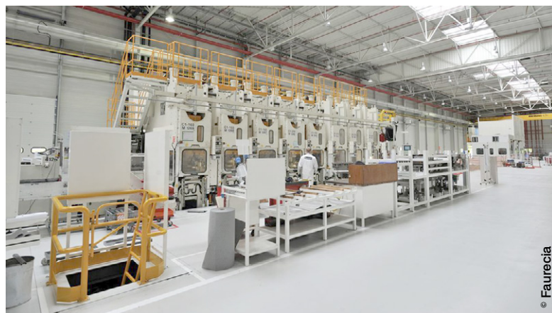
Les presses de l'usine de Caligny permettent de fabriquer les glissières, les articulations du dossier et les systèmes de réglage en hauteur des sièges des automobiles.
