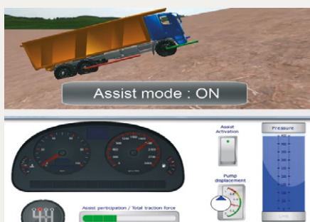
Sans assistance, le camion « patine ». Avec assistance, franchissement de la pente.
