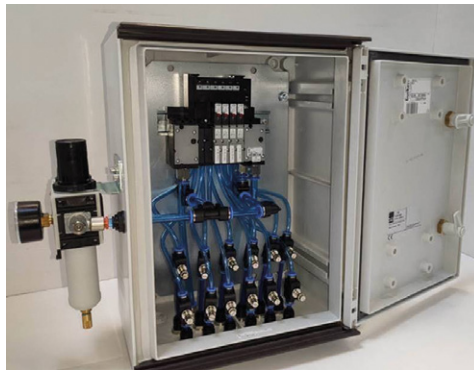
Les îlots pneumatiques proposés par Burkert constituent une autre forme de système intégré.
