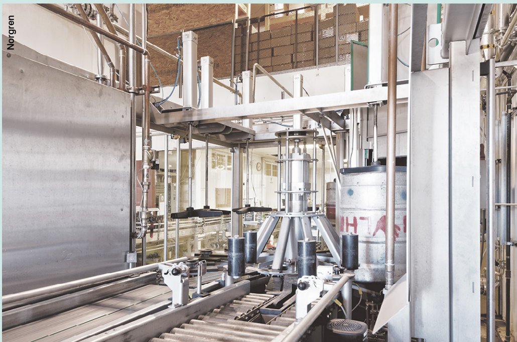
Le rapprochement du vérin et du distributeur permet d'éviter les pertes d'air comprimé et de réduire la consommation d'énergie jusqu'à 50% par rapport à un système conventionnel.
