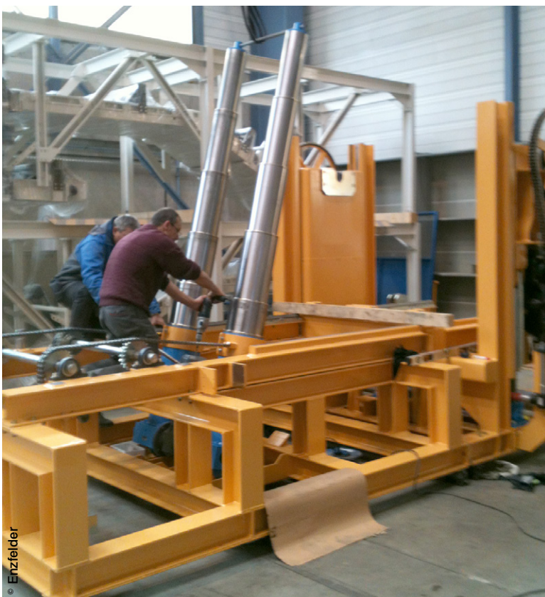
Les vérins mécaniques asservis électriquement de la société Enzfelder répondent à des besoins de déplacement et de positionnement précis et synchronisés.
