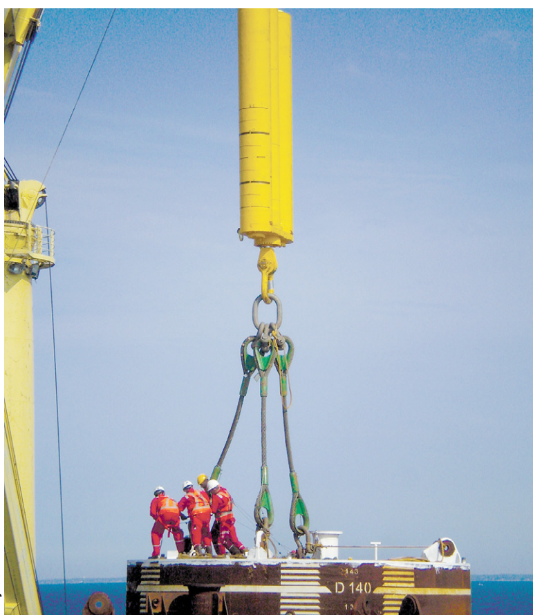
Les vérins Hydac sont notamment utilisés sur des systèmes de compensation de houle.
