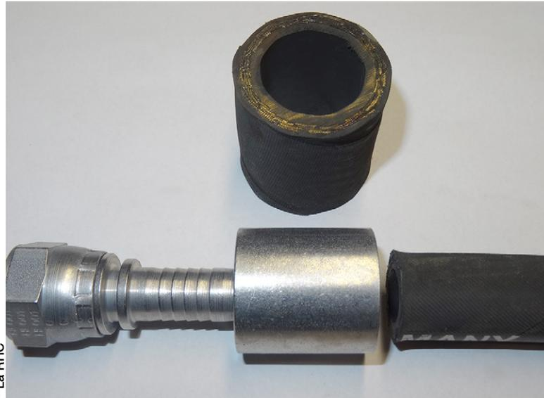
Il ne faut pas utiliser ensemble les tuyaux, embouts et jupes de différents fabricants. Leur non-compatibilité peut amoindrir la durée de vie du flexible et mettre en danger l'opérateur.
