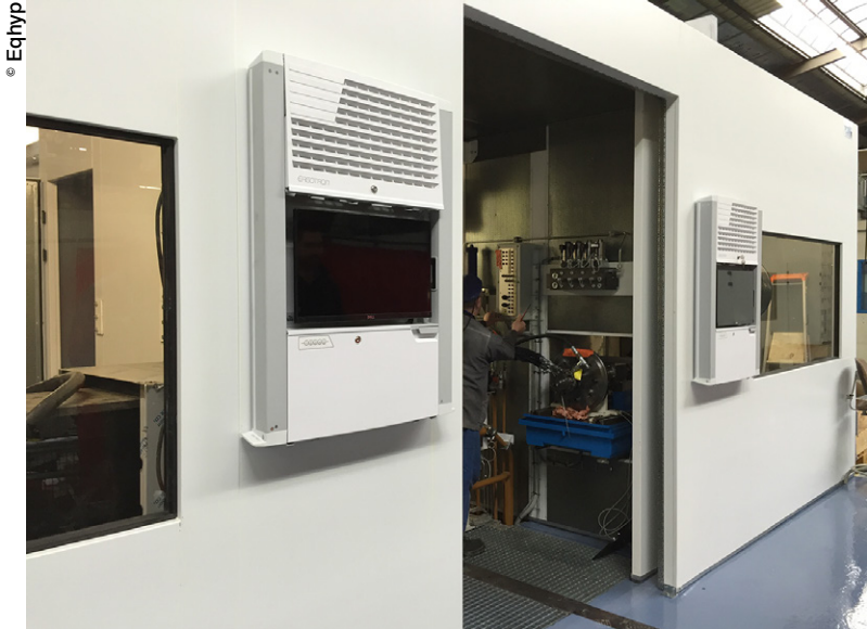
Banc de dépollution et d'essais en fin de ligne de fabrication de moteurs hydrauliques (photos ci-dessus et en bas).
