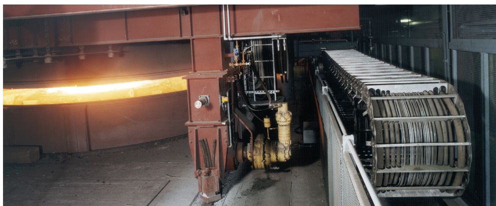
Les chaînes porte-câbles en acier font également leur preuve dans des conditions extrêmes et à des températures élevées.
