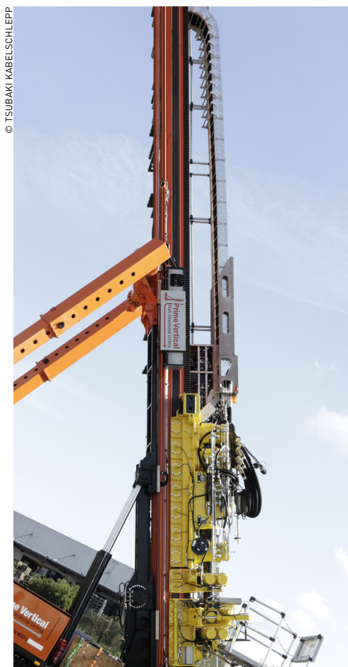
Pour une installation de forage horizontale de la société Prime Drilling, Tsubaki Kabelschlepp a conçu une chaîne en acier spécifique au client placée sur le côté du pylône pour affût de forage.
