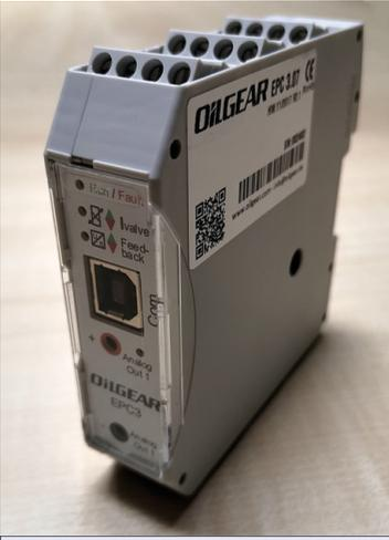
Conçu et fabriqué sur le succès des modèles précédents, le module électronique EPC3 est la troisième génération du module de commande électronique Oilgear. Revisité avec une connectique et un encombrement optimisés, ce module est un microcontrôleur utilisé pour les régulations de pompes et vannes hydrauliques à servocommande. Entièrement programmable par PC grâce à une interface puissante et intuitive, l'EPC3 se connecte en USB et ne nécessite donc aucun câble propriétaire.
