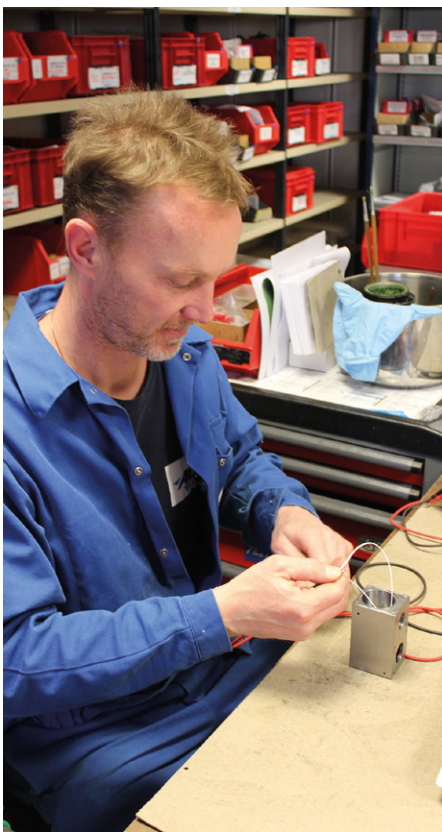
Distributeur hydraulique en cours de montage.
