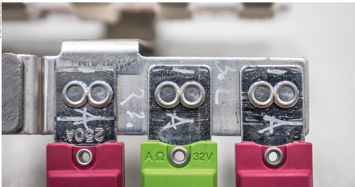
L'outil TOX-TWINpoint permet un assemblage immobile fiable.
