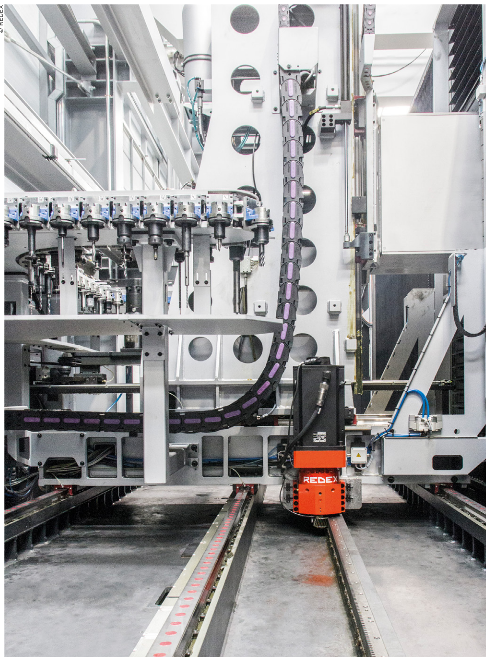
Centre d'usinage à table fixe et montant mobile Ibarmia ZVH multiprocess, vue de côté. L'axe X est entraîné par un ensemble pignon et crémaillère dont l'un des deux réducteur Redex est reconnaissable à sa couleur orange.
