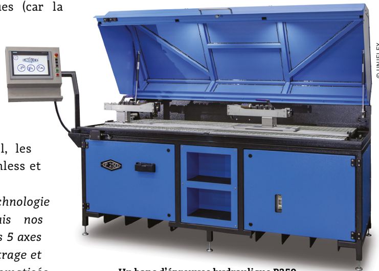
Un banc d'épreuves hydraulique P250 pour tests de pression de composants en rotation.
