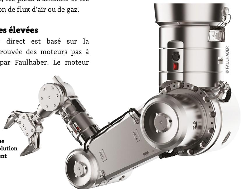
Bras robotique utilisant la solution d'entraînement direct.
