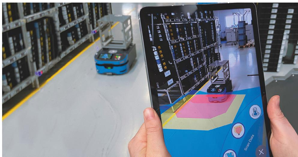
L'application de réalité augmentée SARA permet de rechercher les causes des défaillances directement sur place.
