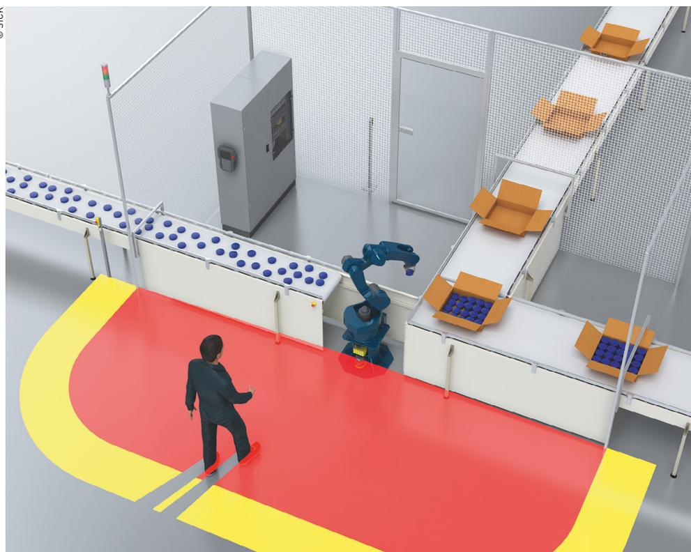
L'application sBot Speed se compose d'un scrutateur laser de sécurité et d'un système de commande de sécurité Flexi Soft.
