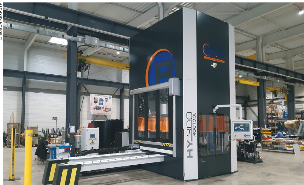
La version hybride est destinée à la fabrication de pièces composites.
