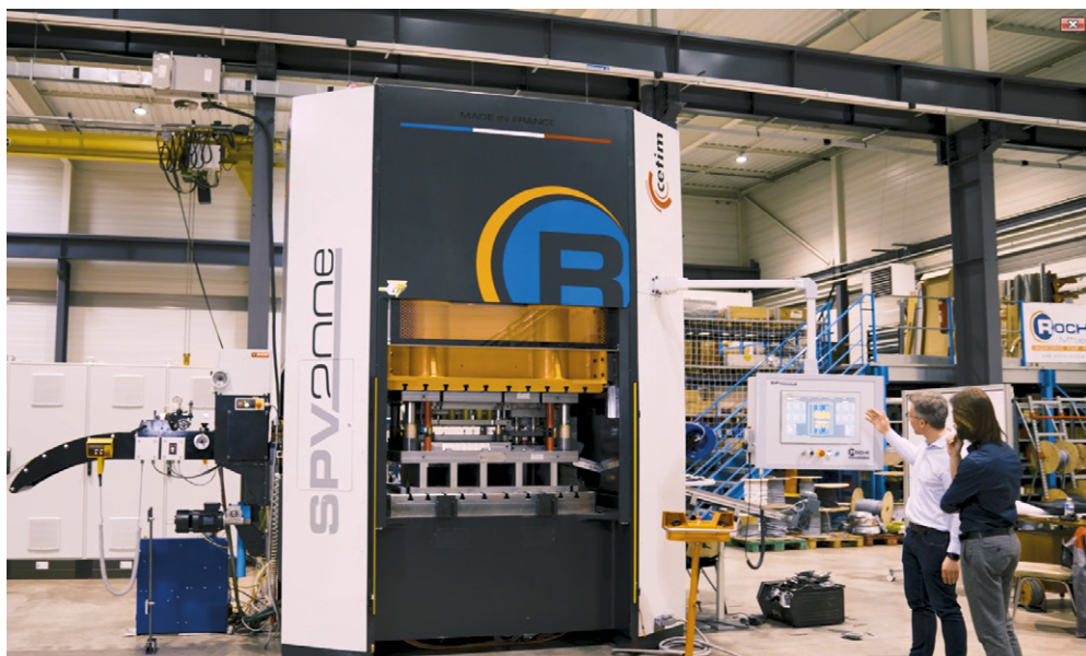
La presse électrique de 200 T assure une cadence de 120 coups par minute avec une puissance de 200 tonnes et une précision au 100°.
