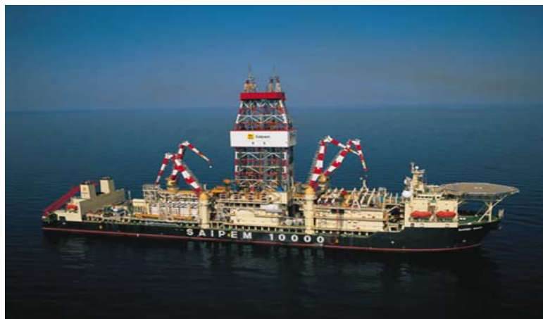
Contrôle d'assiette de barges de forage en grande profondeur au moyen de vérins Eaton Hydrowa équipés du système Hypos Barge SAIPEM : profondeur maxi de forage : 10 000 m, profondeur d'eau maxi : 3000 m, 97 000 tonnes, longueur : 228 m, largeur : 42 m, hauteur : 120 m Maintien hydraulique de la position horizontale par 6 vérins montés sur suspension cardanique et compensation des effets du vent, des vagues et de la houle.
