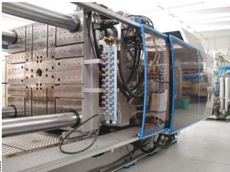
Utilisation du HBS 50 pour l'alimentation en fluides de presses thermoplastiques chez BMP spa.
