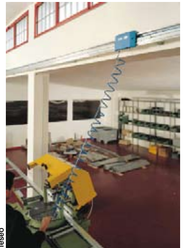
LATS (Air Track Supply) alimente, en air et en électricité, plusieurs outils pneumatiques tout en se déplaçant le long du rail, dont la longueur peut aller jusqu'à 18 mètres.
