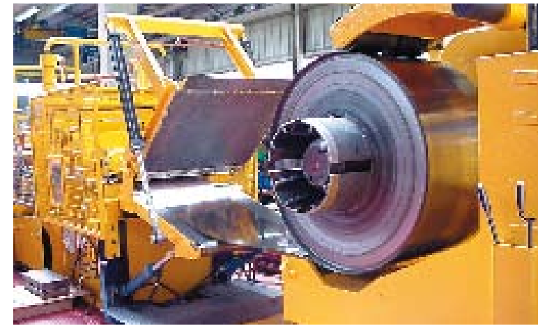
Ligne de déroulage de tôle : Un motoréducteur piloté par un variateur de vitesse régule la force de traction et la vitesse de défilement de la tôle.
