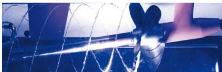
Essai d'une hélice montée. Le gouvernail et le support sont également représentés.
