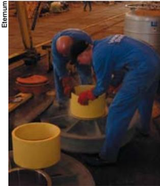
Montage d'une bague en composite antifriction Eternum D-Glide F avec de l'azote (résistance aux températures inférieures à -200°C).
