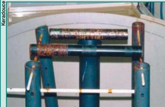
Résultat des tests après 2000h en brouillard salin. En arrière-plan, revêtement Ni/Cr, au premier plan, comparatif Chrome/Keradouce
