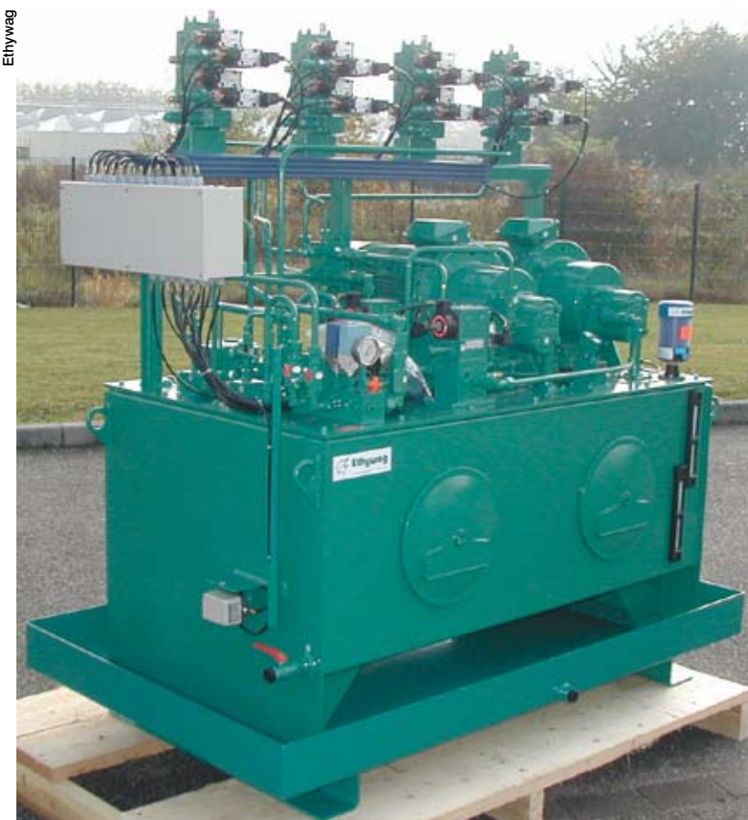
Centrale hydraulique pour machine spéciale
