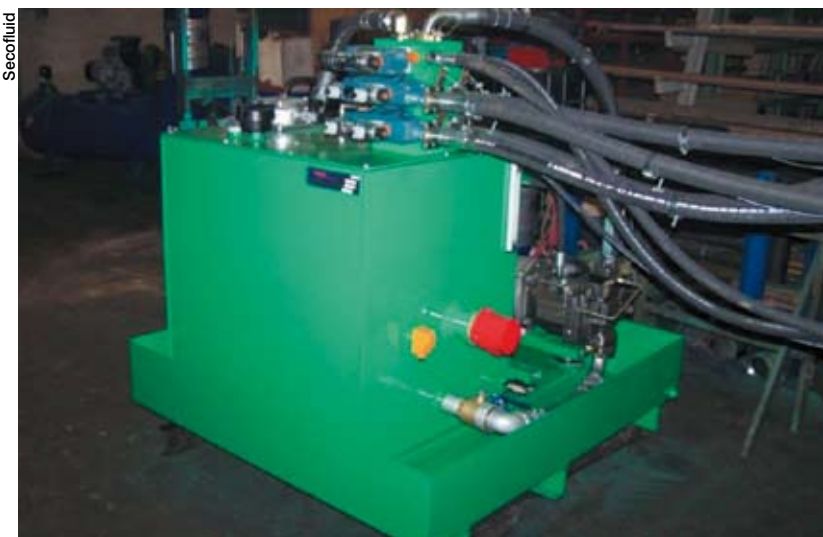
Réalisation de 2 équipements hydrauliques pour l'agroalimentaire avec Revamping complet de la mécanique
