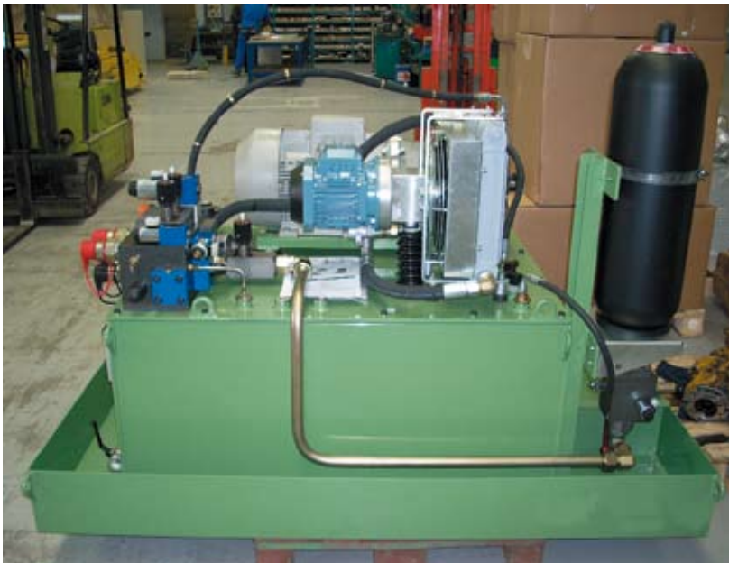
Adaptation d'une solution technique (fonction distribution associée à un accumulateur) ayant permis une augmentation de cadence sur une machine d'emboutissage dans le domaine de la sous-traitance automobile
