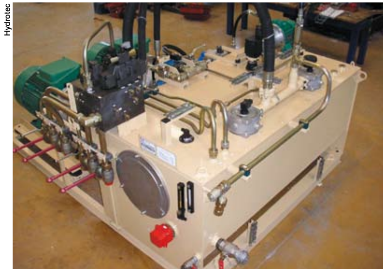
Équipement hydraulique d'aide au lancement et au démarrage d'un moteur électrique de 800 kW à 1450 tr/min
