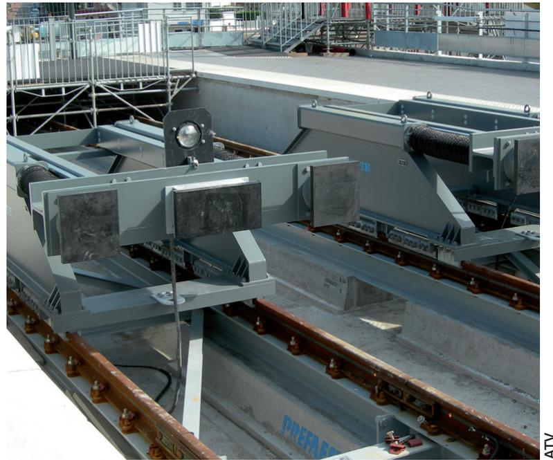
Ce heurtoir mobile permet l'arrêt d'un train de 640 tonnes à 17 Km/h sur une distance de 6 mètres. Le train vient heurter les amortisseurs avant qui peuvent chacun absorber jusqu'à 100 tonnes. La structure métallique est liée aux rails par des patins de frein empilés les uns à la suite des autres, générant ainsi un effort de freinage progressif. L'ensemble se déplace sur le rail jusqu'à l'arrêt du train.
