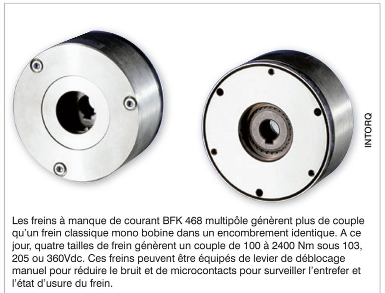
Les freins à manque de courant BFK 468 multipôle génèrent plus de couple qu'un frein classique mono bobine dans un encombrement identique. A ce jour, quatre tailles de frein génèrent un couple de 100 à 2400 Nm sous 103, 205 ou 360Vdc. Ces freins peuvent être équipés de levier de déblocage manuel pour réduire le bruit et de microcontacts pour surveiller l'entrefer et l'état d'usure du frein.
