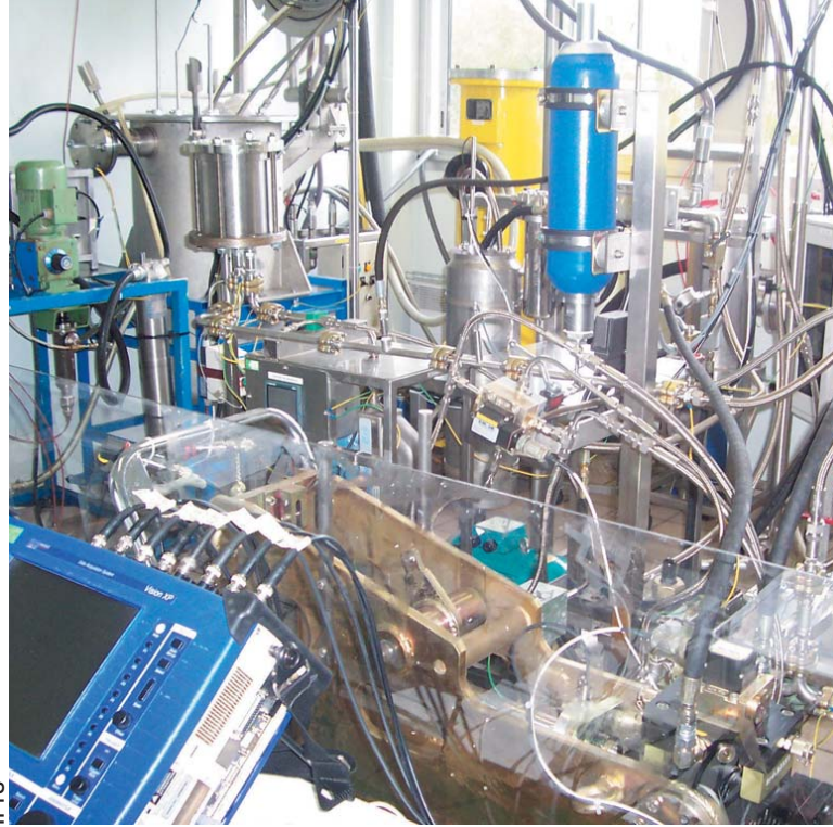
L'essai d'usure : seule base indiscutable d'une exigence propreté (ici une servovalve de train d'atterrissage en essai 380 h)
