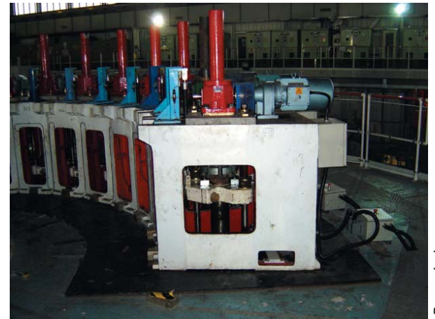
Vérins à vis de Power Jacks soulevant les obturateurs sur la cible
