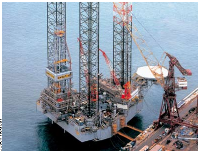
Le principe de Jacking est utilisé notamment pour les plateformes, navires d'exploration, barges...
