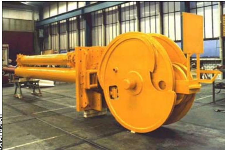
Compensation du mouvement de la houle avec un vérin qui en absorbe l'amplitude
