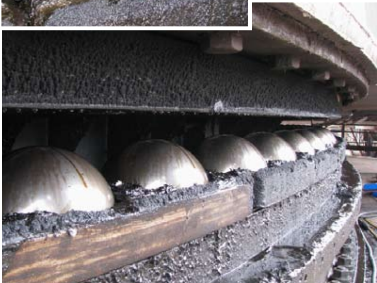
La drague est équipée d'un palier de couronne de rotation de 15,2 m de diamètre qui contient 177 billes présentant un diamètre de 200 mm et un poids de 32 kg chacune.
