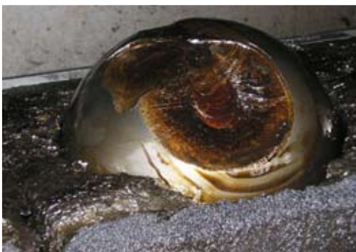
Bille de rotation abîmée de 32 kg et d'un diamètre de 200 mm provenant de la bague de roulement à billes d'orientation de la machine géante.
