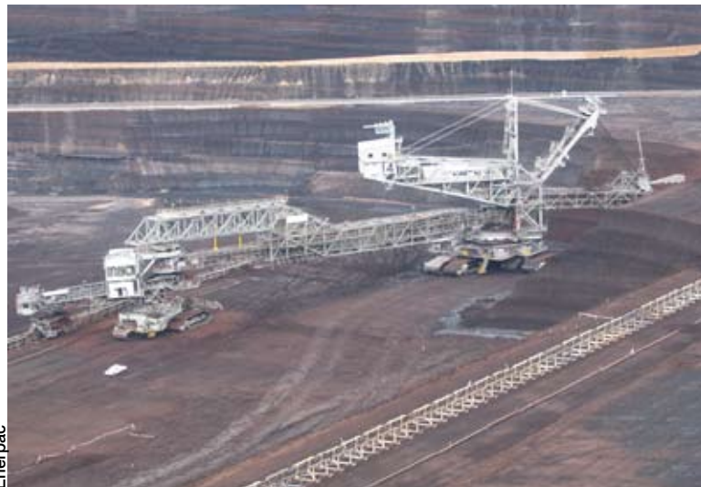
Cette drague de mine est capable de déblayer 60 000 tonnes de roche de recouvrement par jour.
