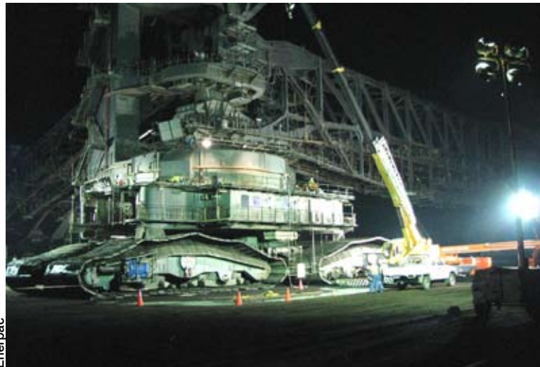
La technologie de levage synchronisé Enerpac a été choisie pour effectuer le levage de cette drague de mine à charbon pesant 5000 tonnes. Ceci afin d'inspecter et de réaménager la bague de roulement à billes d'orientation de la machine géante, tout en surveillant le centre de gravité de la charge de 2200 tonnes.
