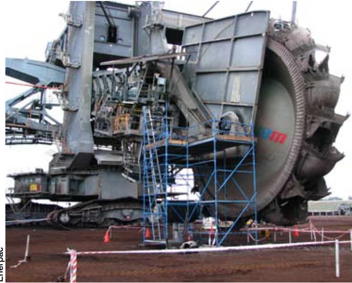
Cette drague de mine à charbon de 5000 tonnes possède une longueur de 200 m et une hauteur de 55m
