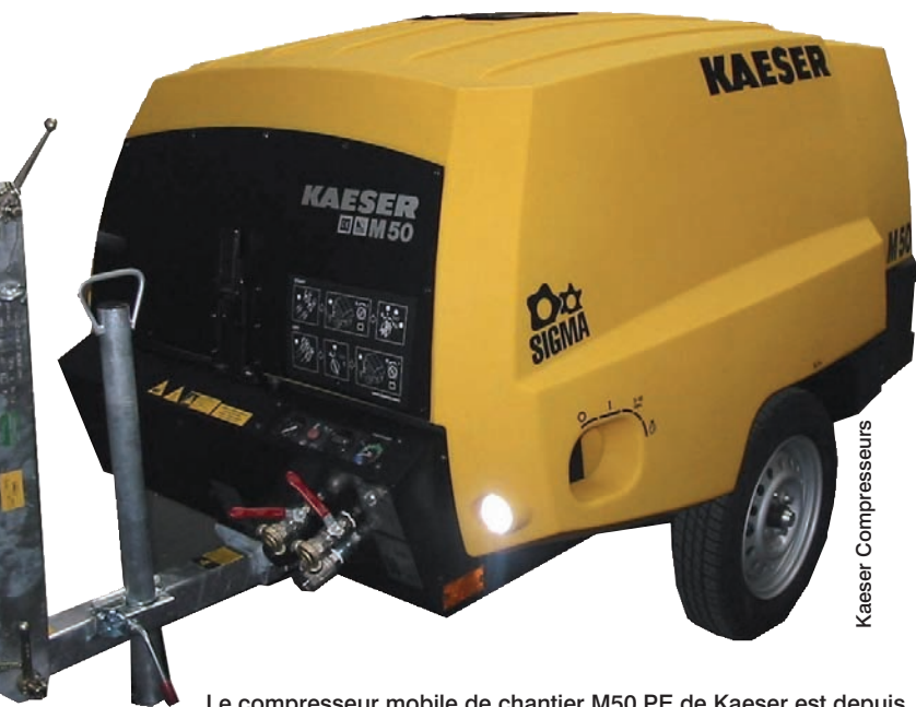
Le compresseur mobile de chantier M50 PE de Kaeser est depuis peu disponible avec un capot polyéthylène rotomoulé.
