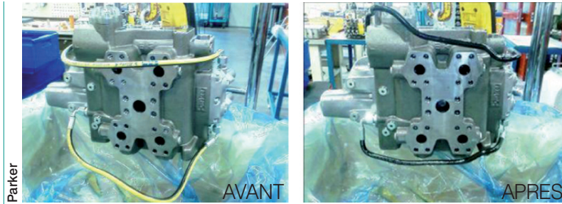
Les tuyaux de Parker se distinguent par leur bonne tenue à la pression et aux variations de température. Et parcequ'ils sont fiables, il n'y a aucun risque de microfuites dont les conséquences sont souvent graves pour le personnel.
