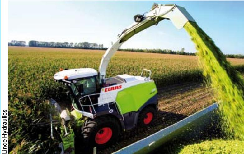
On enregistre la vitesse sélectionnée du Tempomat dans la commande CED de Linde Hydraulics. Ceci permet à l'opérateur, après avoir effectué un virage, de continuer sa route exactement à la même vitesse.
